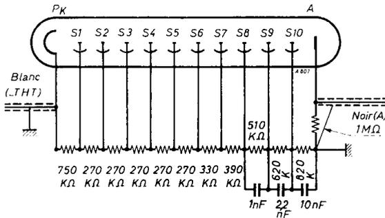
La présence de la résistance de 1 M $\Omega$  dans le circuit anodique permet la mesure du signal continu :
