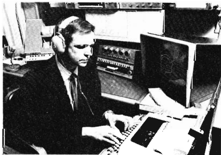
Photo 22. — C.-H. Coker, frappe sur un clavier le texte à dire à haute voix par l'ordinateur. Sur l'écran cathodique apparaît le conduit vocal que l'on simule, et dont on analyse le comportement.
