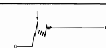
Fig. 7. — Rebondissements à la fermeture d'un interrupteur. Un monostable « non redéclenchable » basculera à la première pointe positive et ne sera pas affecté par les suivantes.
