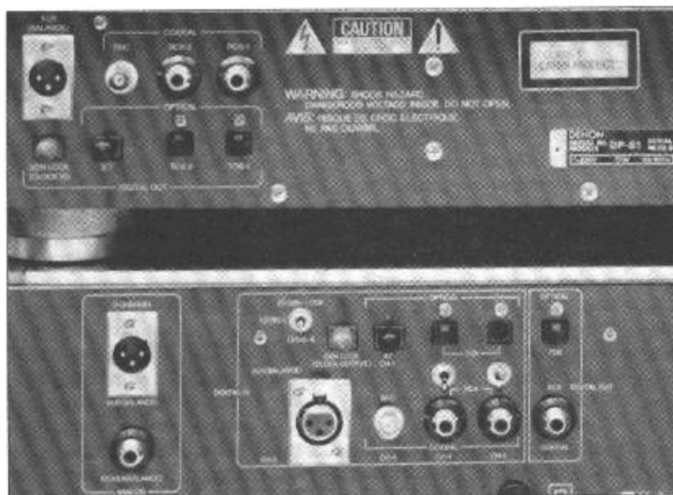
Vue arrière de l'ensemble DP-S1/DA-S1. On remarque la présence de nombreuses entrées et sorties, incluant des liaisons symétriques XLR et optique AT&T.
