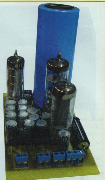
Le module alimentation stabilisée.
